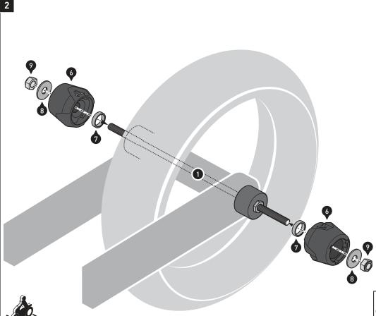
Montieren Sie die Sturzpads (6) mit den Muttern (9) **beidseitig** an der Gewindestange (1). Ziehen Sie die Muttern (9) wie vorgegeben an.
