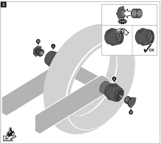
Setzen Sie **beidseitig** die Abdeckkappen (10) in die Öffnungen der montierten Sturzpads (6) ein und drehen Sie diese bis in die Endposition.
