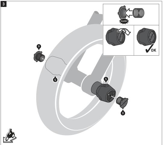
Setzen Sie **beidseitig** die Abdeckkappen (9) in die Öffnungen der montierten Sturzpads (5) ein und drehen Sie diese bis in die Endposition.
