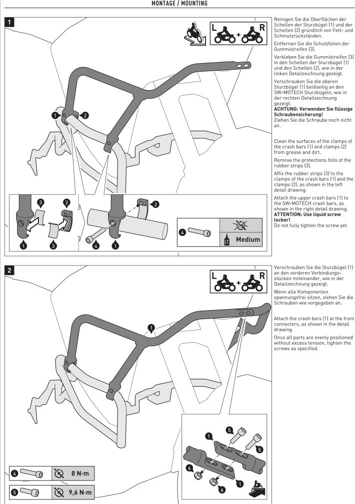
Verschrauben Sie die Sturzbügel (1) an den vorderen Verbindungs-stücken miteinander, wie in der Detailzeichnung gezeigt.
