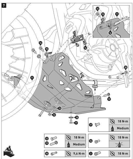
Verschrauben Sie den Motorschutz (11) an den Anbaublechen (1) und (2), und dem Fahrzeugrahmen, wie in der Zeichnung gezeigt. **A WARNUNG: Verwenden Sie** flüssing Schraubensicherung für
