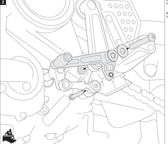
Entfernen Sie den original Schalthebel vom Fahrzeug.
