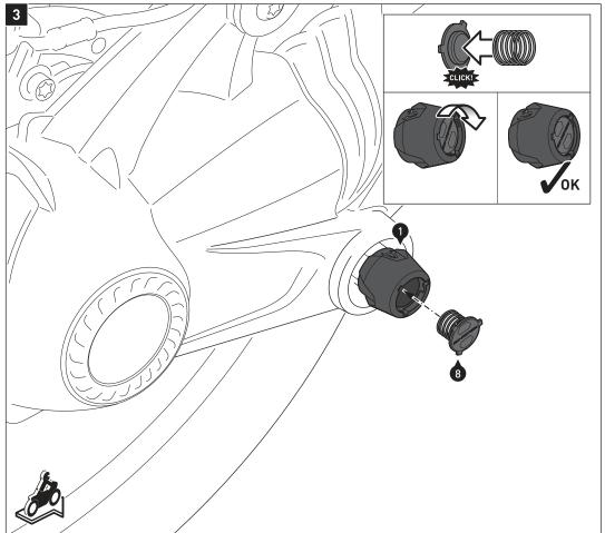
Setzen Sie die Abdeckkappe (8) in die Öffnung des montierten Sturzpad (5) ein und drehen Sie dieses bis in die Endposition.
