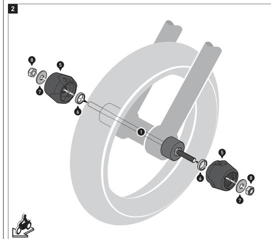
Montieren Sie die Sturzpads (5) mit den Muttern (8) **beidseitig** an der Gewindestange (1). Ziehen Sie die Muttern (8) wie vorgegeben an.
