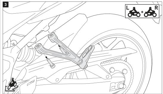
Entfernen Sie die gezeigten original Schrauben vom Fahrzeug.
