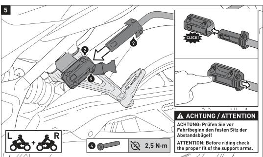
Stecken Sie die Stecker (9) beidseitig in die Steckeraufnahmen (2). Achten Sie beim Einschieben auf das deutlich hörbare Einrastgeräusch!
