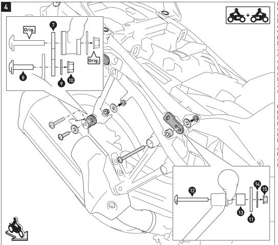
Nur rechte Fahrzeugseite: Verschrauben Sie die Endtopfverlegung (7) mit den original Teilen (Orig.) am Fahrzeug, wie in der oberen Detailzeichnung gezeigt. Verschrauben Sie anschließend den Endtopf an den Endtopfverlegung
