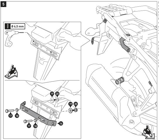
Bohren Sie mit einem 6,5-mm-Bohrer die Befestigungsbohrungen des Querverbinders (16), wie in der Detailzeichnung gezeigt. Entgraten Sie anschließend die Ränder der Befestigungsbohrungen.
