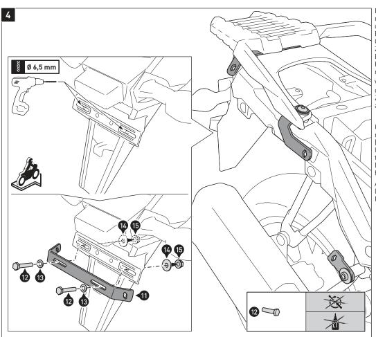
Bohren Sie mit einem 6,5-mm-Bohrer in der Mitte der Vertiefungen des Kennzeichenhalters die Befestigungsbohrungen des Querverbinders (11), wie in der Zeichnung gezeigt. Entgraten Sie anschließend die Ränder der Befestigungsboh-
