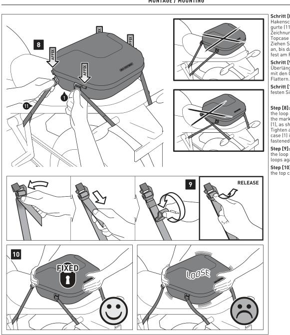
Schritt [8]: Befestigen Sie nun die Hakenschnallen der VIER Schlaufgurte (11) beidseitig an den in der Zeichnung gezeigten Schlaufen des Topcase (1).
