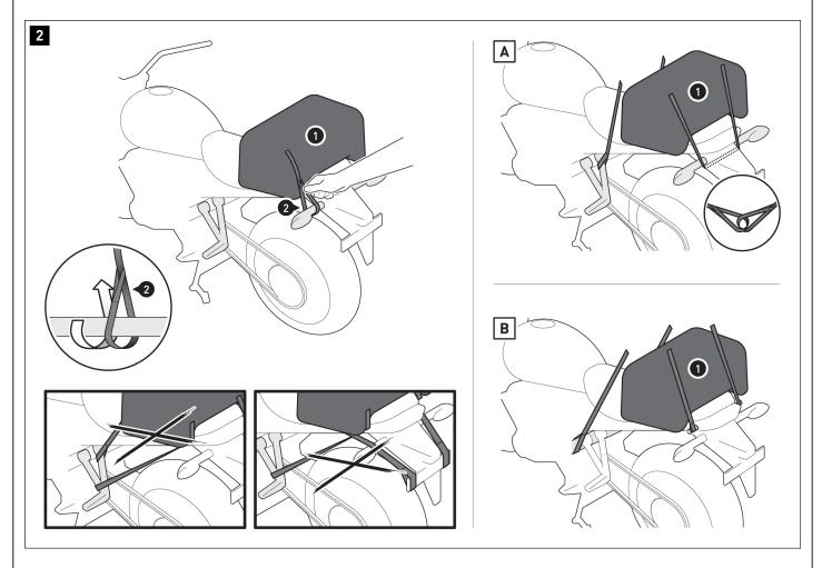
Enroulez les sangles d'arrimage (3) à **QUATRE** points de fixation appropriés et resistants sur le véhicule, comme indiqué sur le dessin et les exemples de dessins**[A]** et**[B]** (p. ex. support de repose-pieds, cadre du véhicule, crochet à bagages, etc.).
