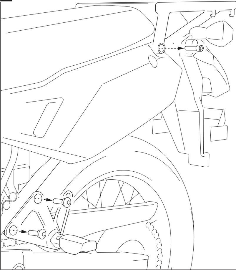
**HINWEIS:** Die Montage ist linksseitig dargestellt. Wiederholen Sie die Montage mit den entsprechenden Teilen auf der rechten Fahrzeugseite analog zur linken Fahrzeugseite.
